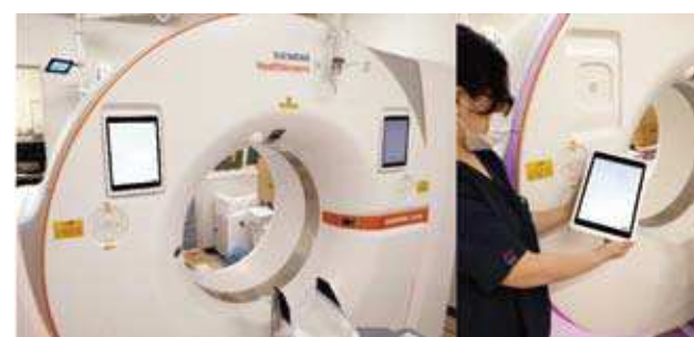
(図3) タブレット端末を使用して患者選択・登録から撮影プロトコルの選択、撮影範囲の設定や画像確認まで行うことが可能
