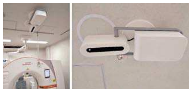
(図2) 天井に取り付けたカメラ(左) カメラ(右) ボタン一つで人体を認識する
